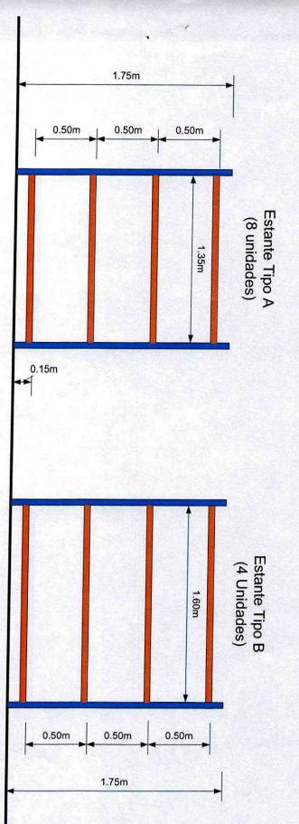
Profundidad de cada anaquel 60 cm Anaqueles con perfilería de metal galvanizado o aluminio minimo de 11/2"
